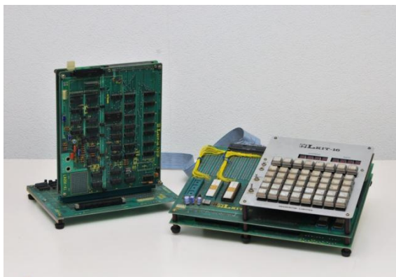
Lkit-16: 国内初の1チップ16ビットマイクロコンピュータ(1975)、2010年に情報処理技術遺産に認定
